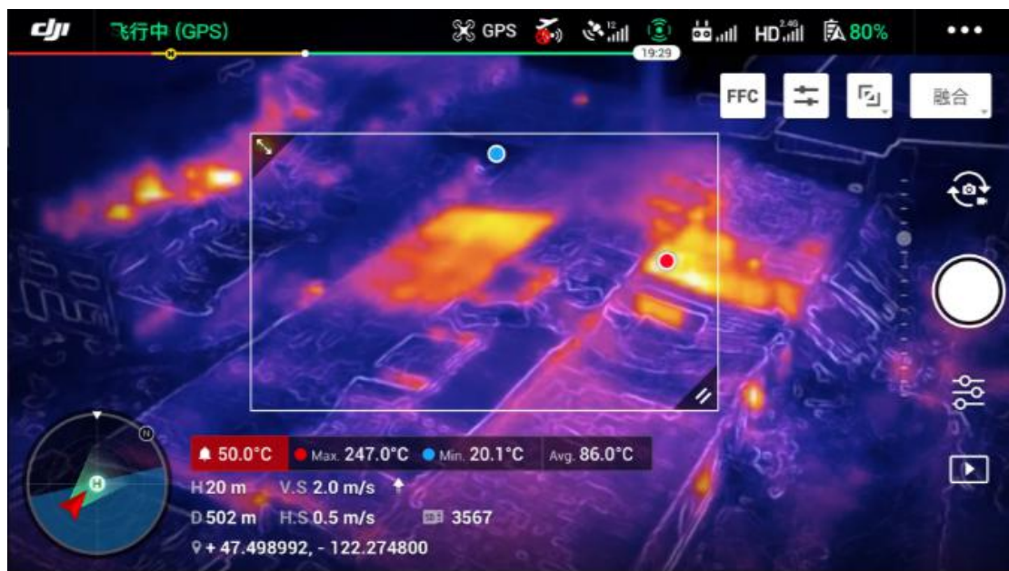
扫描区域温度，显示区域内最高温度、最低温度、平均温度
